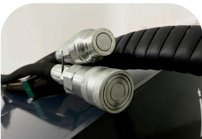
Быстроотъемные соединения для гидравлической линии мини-погрузчика уже включены в базовую комплектацию.
