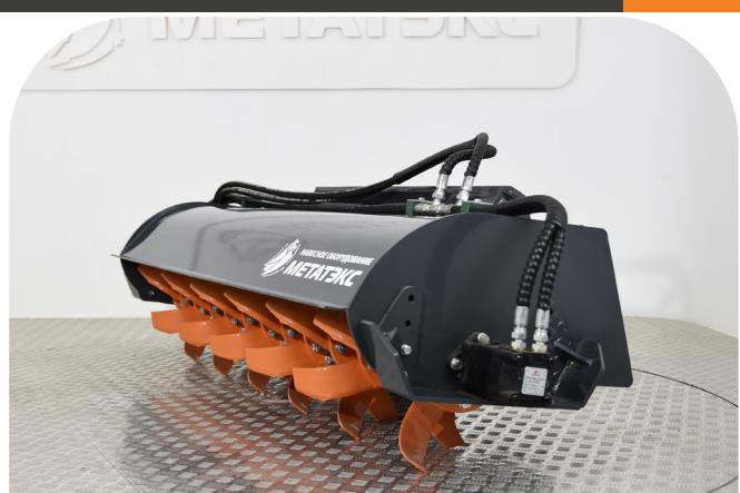
Преимущество использования двух моторов заключается в равномерном распределении крутящего момента по валу. Дополнительные муфты, закрепляющие вал, снимают ударную нагрузку с гидромоторов, предотвращая поломку культиватора.
