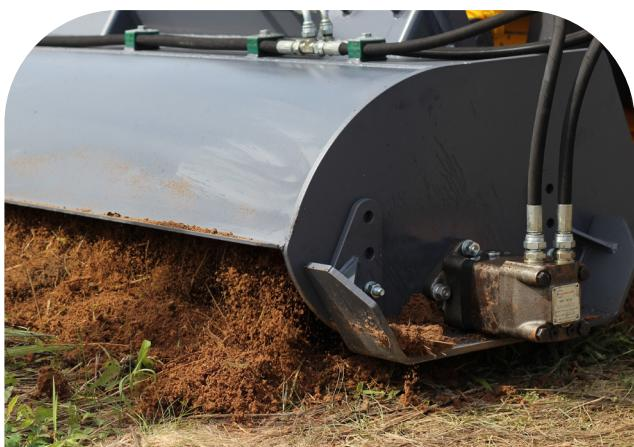
Опорные лыжи навесного культиватора предназначены для регулировки глубины рыхления почвы. Они имеют три фиксированных положения: 70 мм, 140 мм и 200 мм.
