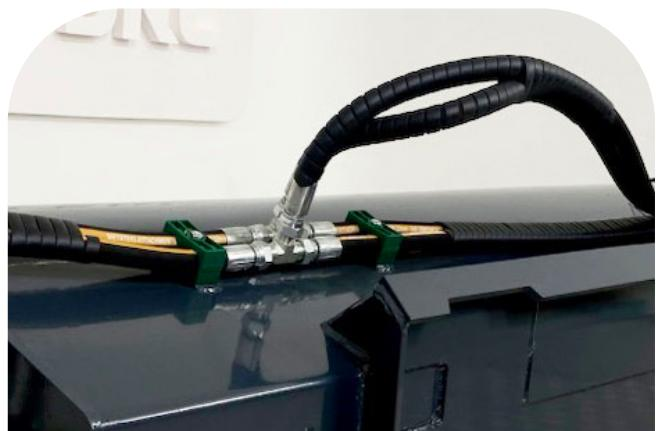
Культиватор оснащен надежными рукавами, которые рассчитаны на работу под давлением до 270 бар.
